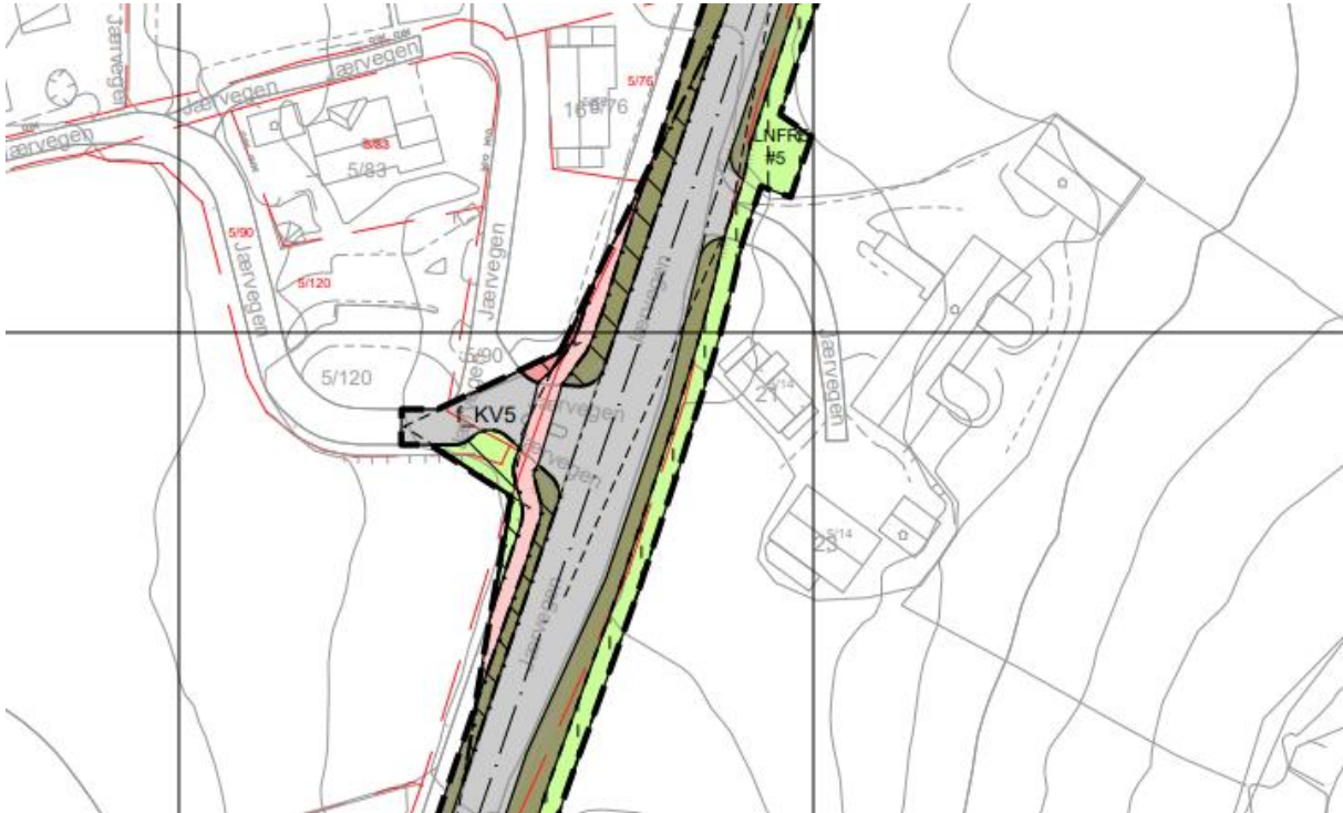
Figur 28. Utsnitt av kartblad 2 i detaljregulering for strekning Klepp grense til Vigre (plan 4 - Hå 1) som viser det lille arealet i siktsona til avkjøringen merket f_KV5 som er offentlig og privat tjenesteyting.
