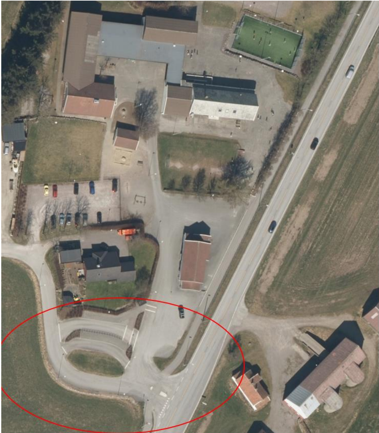
Figur 37. Utklipp av ortofoto som viser løsningen ved Høyland skule der det er satt av eget areal til på- og avstigning av skolebuss.
