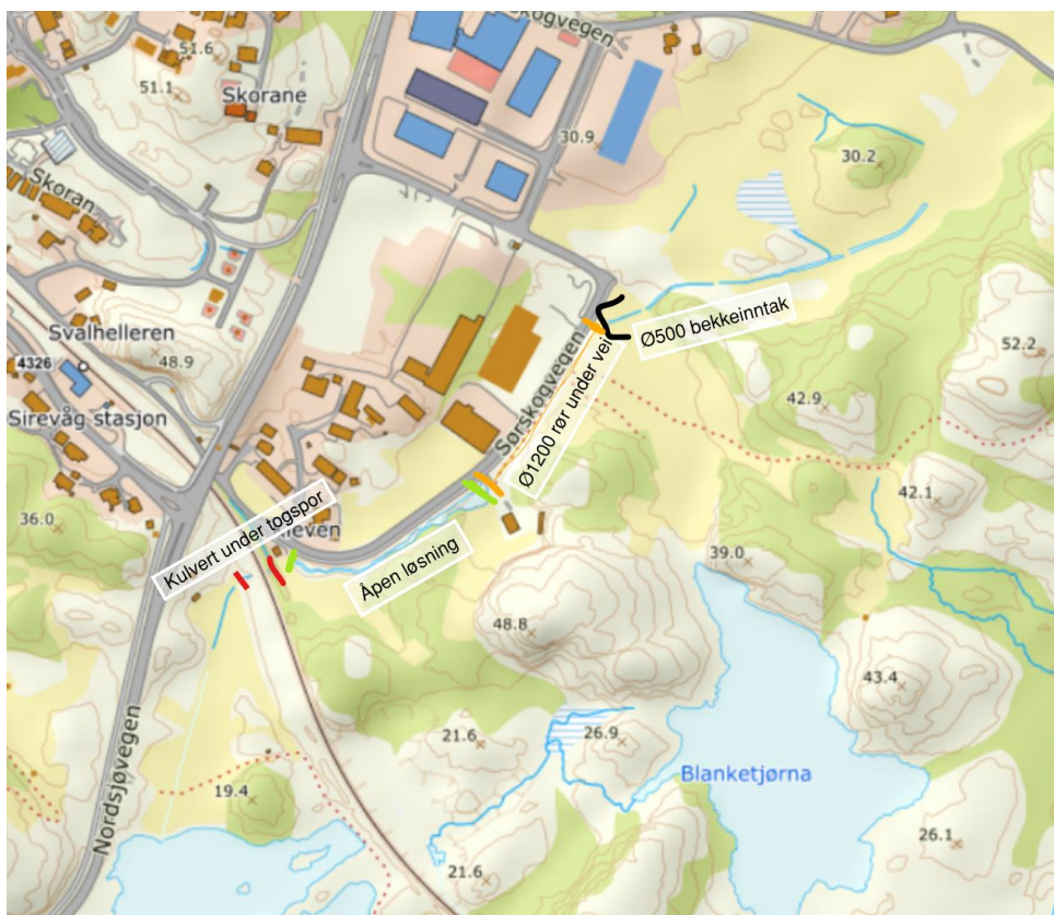
Figur 3-3 Dagens overvannsrør langs veien Skoga industri.
