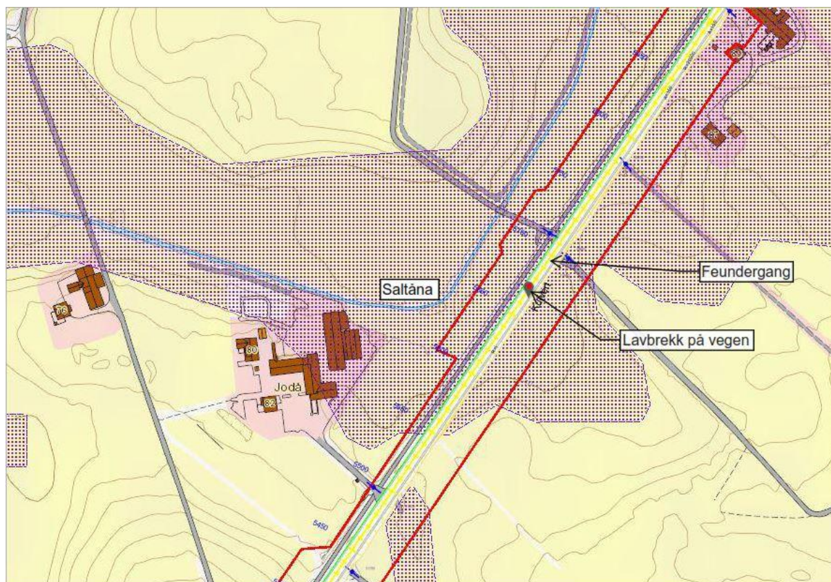
Figur 4-13. Kartutsnittet viser ein feundergang ved vegprofil 5700 som også er utsett for flaum frå Saltåna. Denne kan også fungere som en open vassveg ved store regnhendingar
