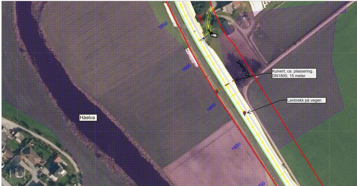
Figur 2-16. Lavbrekk ved vegprofil 1827, landbrukskulvert og skravert område frå NVEs aktsemdskart for flaum.
