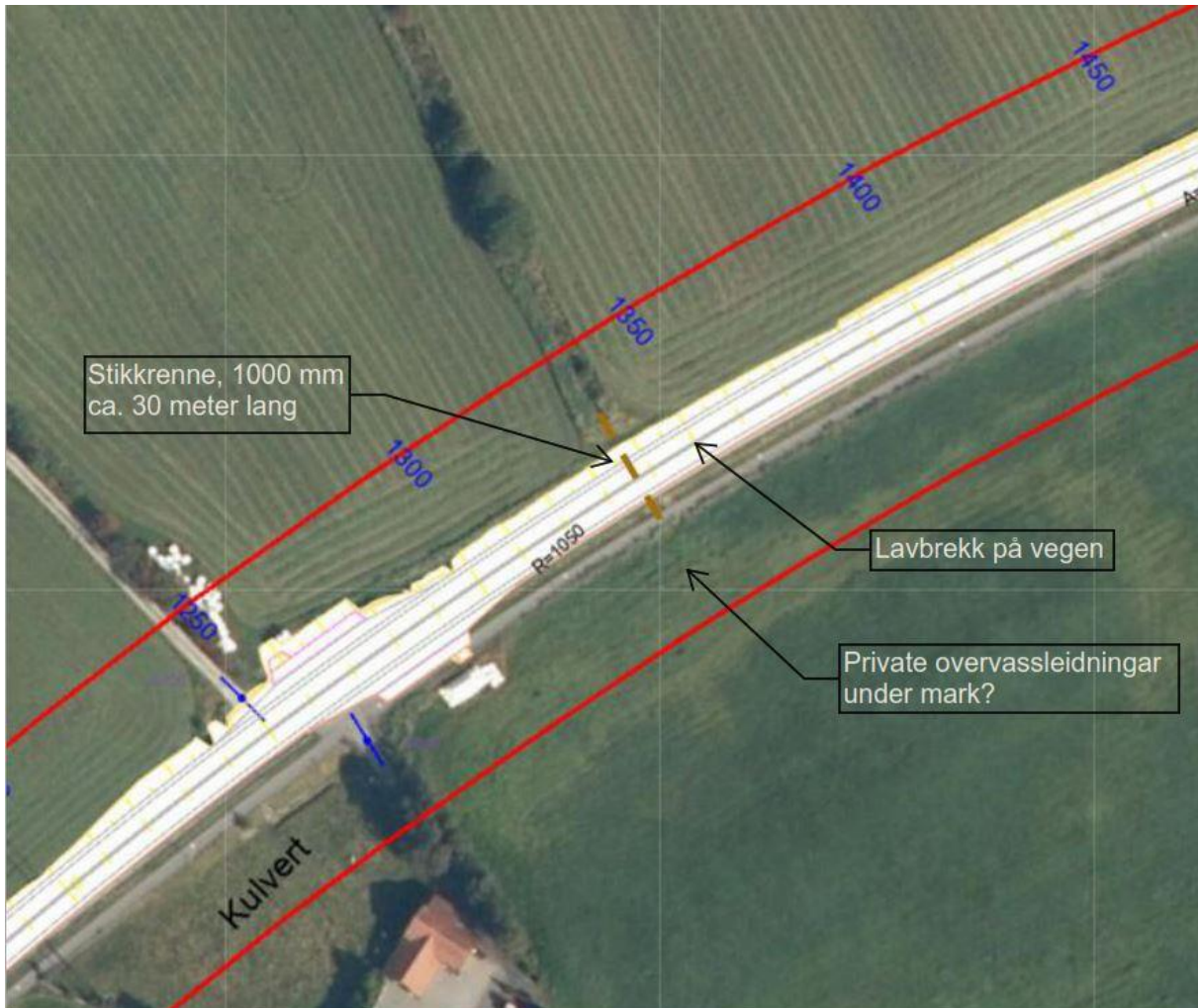
Figur 2-6. Lavbrekk ved vegprofil 1350 og stikkrenne i nærheita.
