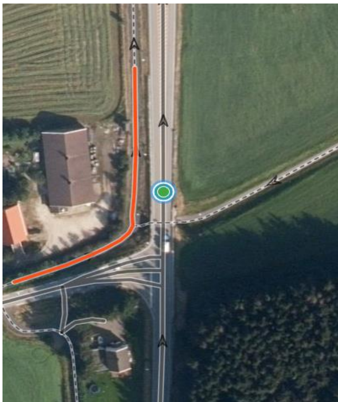
Figur 3-4 Kryss, Vigre (Vegkart, Statens vegvesen). Raud linje indikerer open grøft, medan grøn linje indikere lukka røyrgrøft /røyrleidning.
