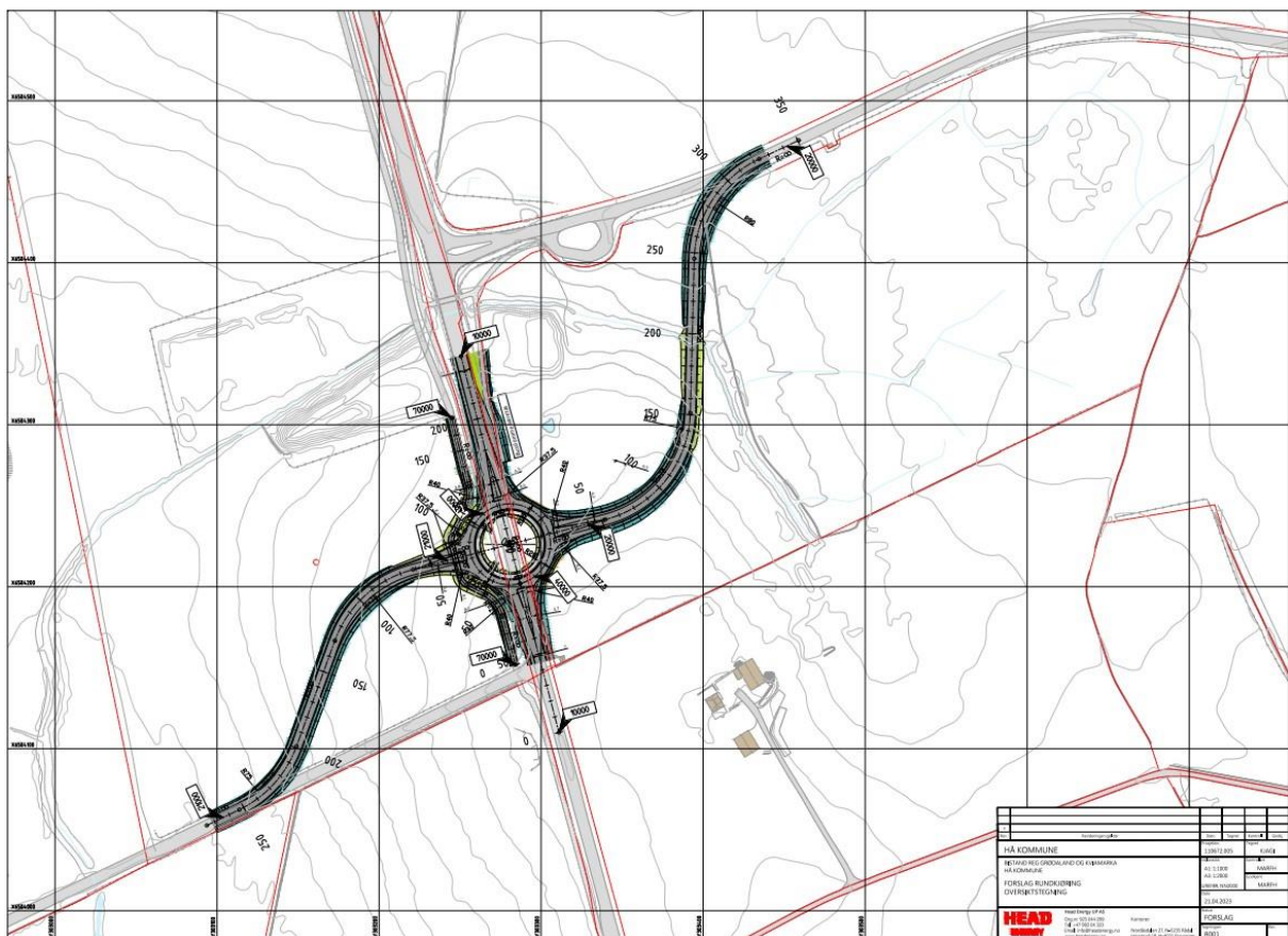
Figur 32: Skissert rundkjøringsløsning med avkjørsler til næringsområdene Kviamarka og Grødaland.
