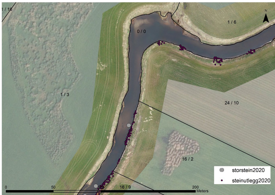
Figur 5: Delstrekning 2: Anbefalte justeringer til kantsikringen med utlegg av stein og enkelte blokk for å skape mer variert elvekant.
