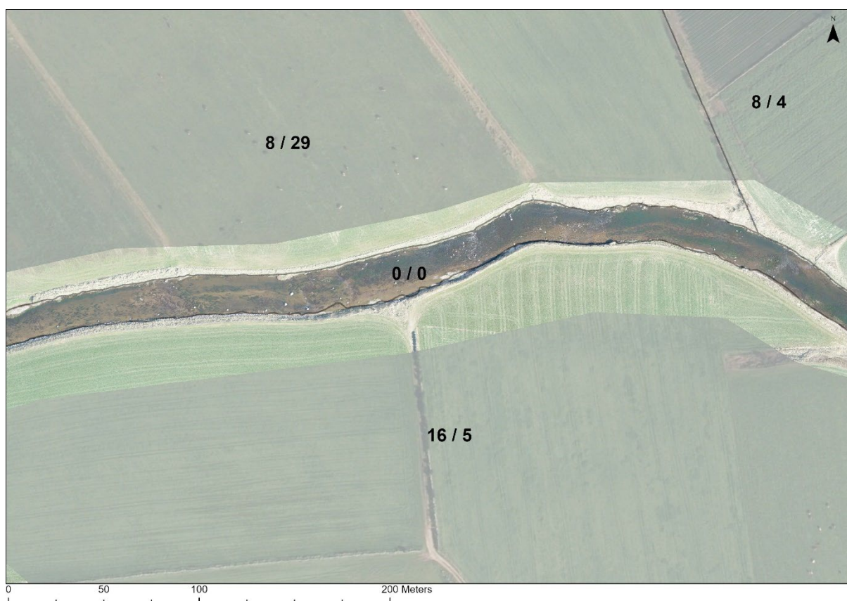
Figur 32: Delstrekning 13. Det ble lagt ut stein og en god del blokker som gir varierte strømforhold og en fin elv-i-elv-utforming ved lav vannføring. Rundt blokkene har det dannet seg en del fine gyteplasser.
