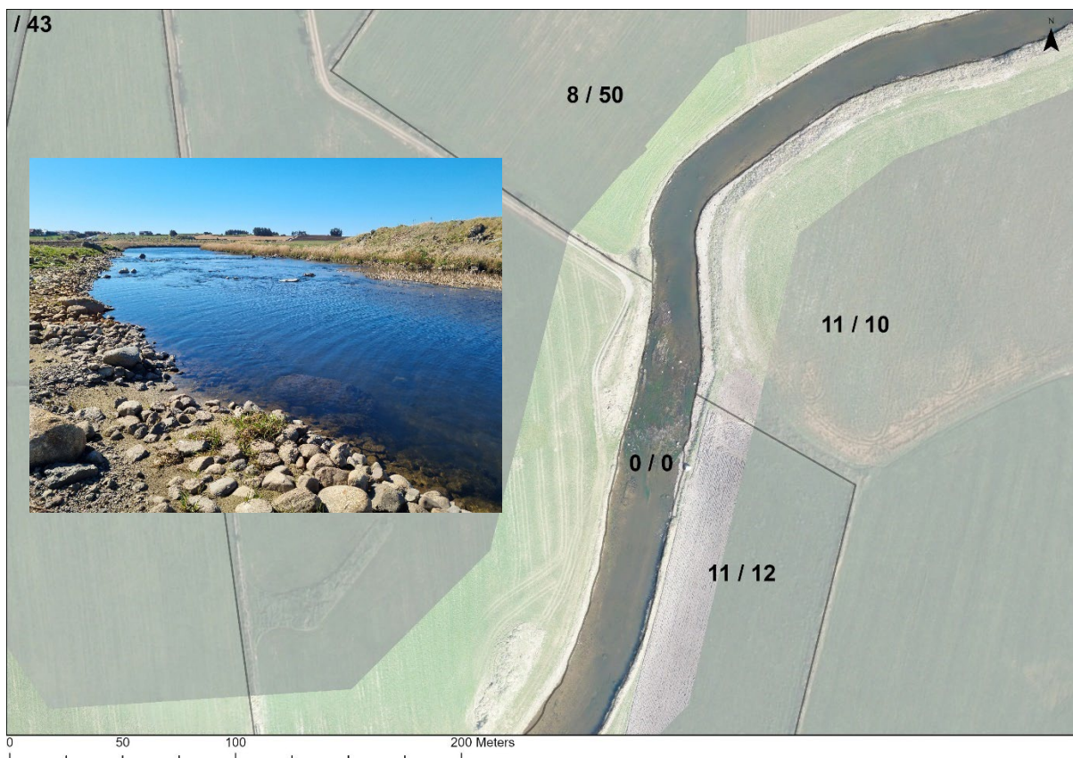
Figur 44: Delstrekning 18. Steinutlegg har gitt mye skjul i kantsonen. Tilbaketrekking av skråningen har økt tverrsnittet. Blokkutleggene har bidratt til strømvariasjon, særlig i midtre del av delstrekningen.
