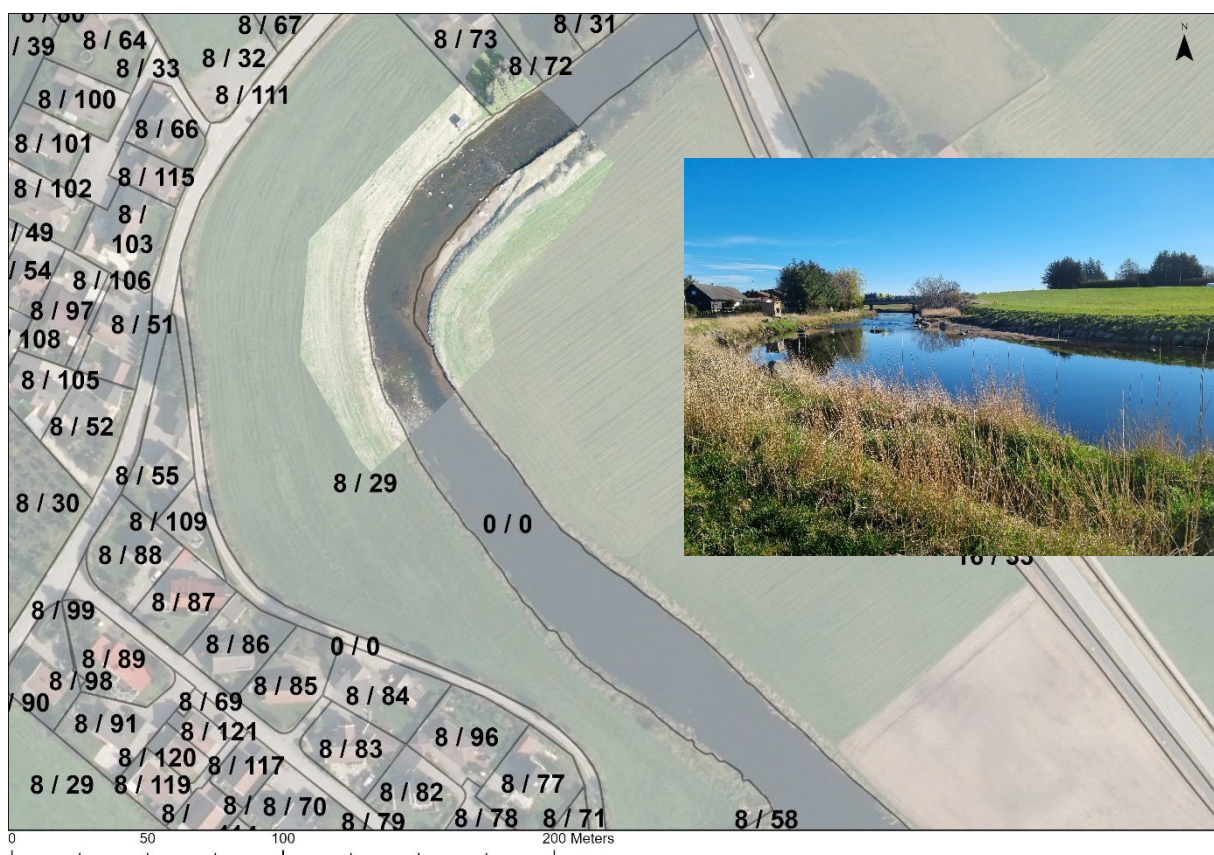
Figure 25: Delstrekning 10. Terrenget ble senket til vannflaten og det ble ikke gjort tiltak for habitatvariasjon. Det forventes ingen positiv effekt på fiskehabitat i denne strekningen, og oppbygging av terreng må forventes over tid grunnet redusert skjærspenning.
