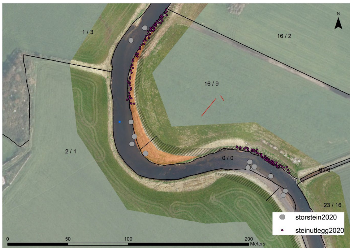
Figur 7: Delstrekning 3. Tiltakskart fra 2020 med senkning av indre svinger til 0.5 m over vannflate, tilbaketrukket skråning, utlegg av løse steinmasser som erosjonssikring for variert elvekant og utlegg av blokk for habitatvariasjon.
