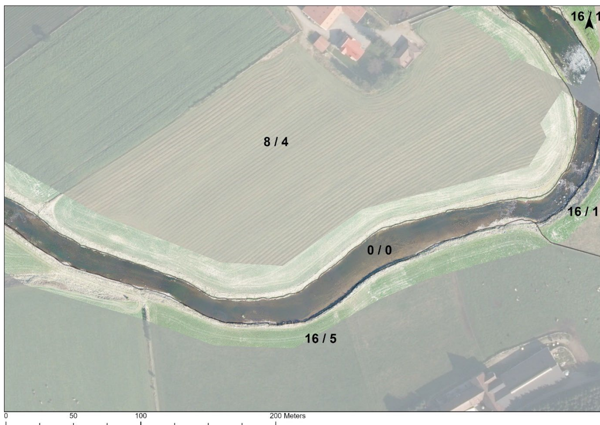
Figure 30: Delstrekning 12. Øverste delstrekningen i avsnittet ble droppet grunnet tilstrekkelig høy habitatvariasjon. Det ble fjernet avleiringer i midtre og nedre delen og det ble lagt ut en del stein og blokker som gir en bra variert elvekant.
