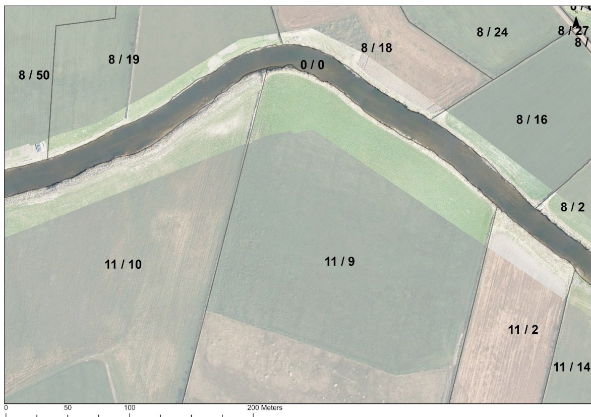
Figur 42: Delstrekning 17. Noen erosjonssoner ble sikret med stein, noe som vil redusere mobilisering av finsediment. I nedre delstrekning ble skråningen modifisert. Hele strekket langs 11/10 ble plantet med trær i 2022.
