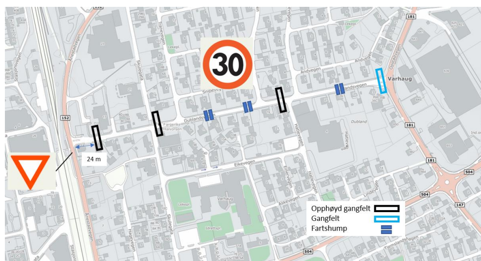
Figur 39 Prinsippskisse visende fartsdempende tiltak i Dublandsvegen. Kartgrunnlag 1881.no.
