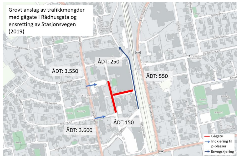
Figur 36 Grovt anslag av trafikkmengder ved etablering av gågate og forbindelse mellom Dysjalandsgata og parkeringsplasser samt envegskjøring i Stasjonsvegen. Kartgrunnlag 1881.no.
