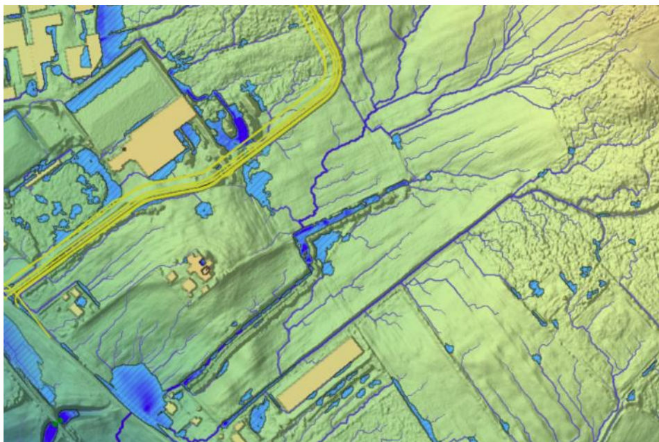
Utklipp fra arbeidsområde i Scalgo. Viser eksisterende situasjon før bekkelukking med ny atkomstveg som avskjærende grøft.
