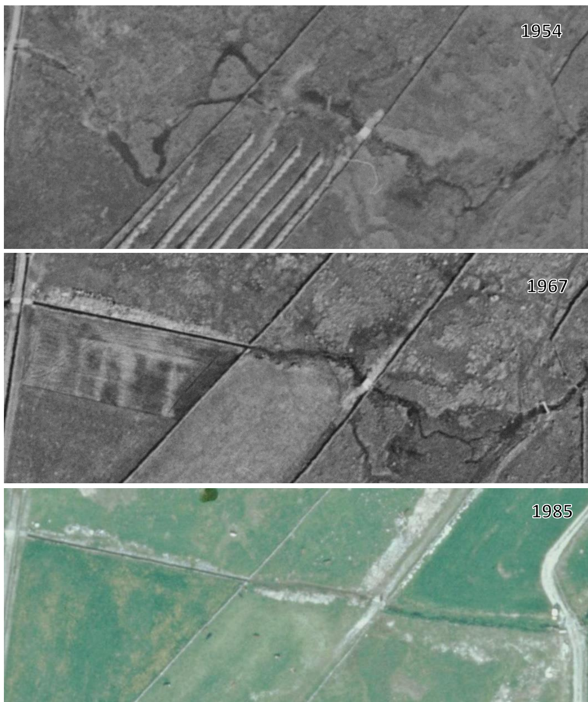
Figur 7. Utretting og kanalisering av elveløpet i øvre del av det sørøstre sideløpet, utrettingen skjedde i perioden 1954 til 1985, elveløpet på strekningen er redusert fra 216 til 164 m.
