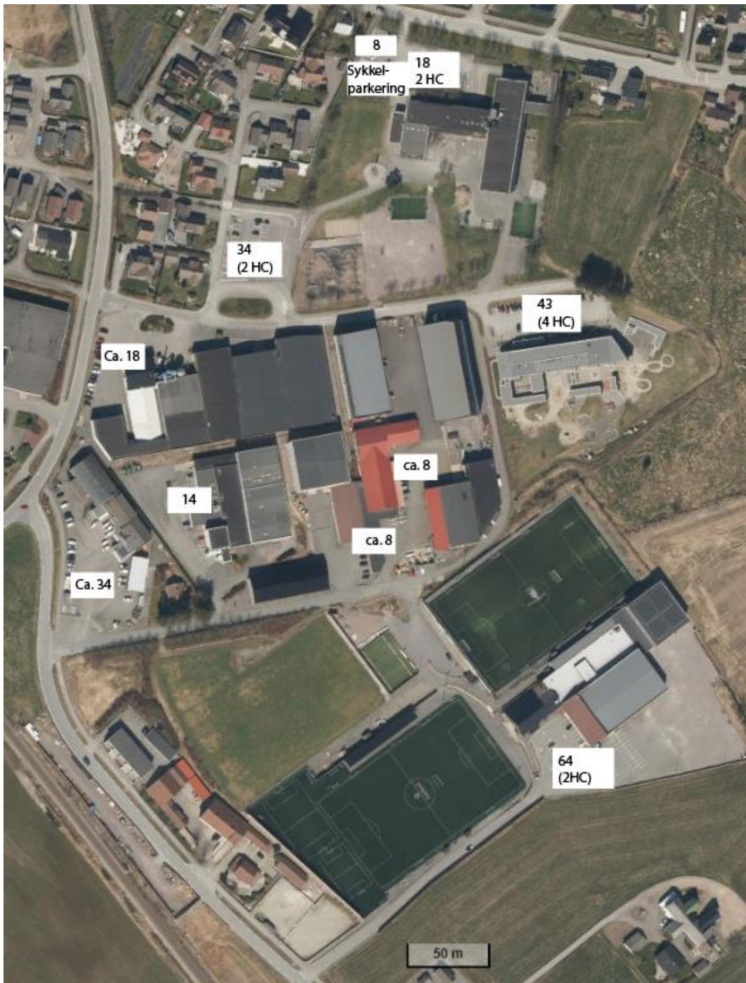
FIGUR 17 Grovt estimert antall parkeringsplasser for bil innenfor plangrensen. Bakgrunnsbilde hentet fra Norgeskart.no.
