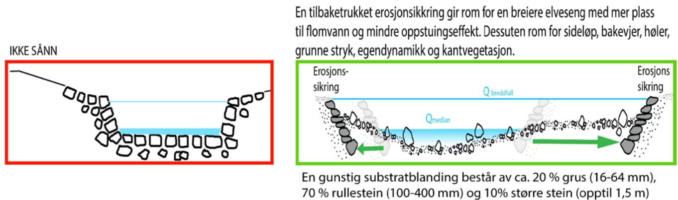
Figur 7: anbefalt utforming av elvetverrsnitt: Forbygning/elvekanten over vann trekkes tilbake så vidt som mulig for å øke avløpstverrsnitt og habitatvariasjon.
