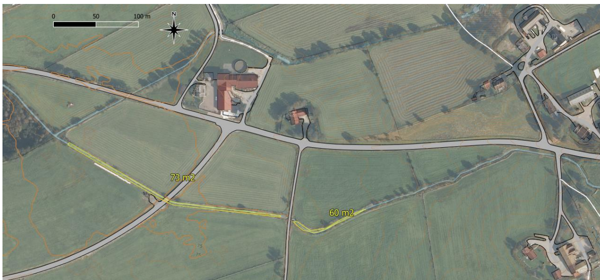
Figur 2-1. I Tjensvollbekken over anadrom sone er det i hovedkanalen blitt avsatt mye masser både i bekkebunn samt langs elvekant, som med fordel kunne fjernes for å frigjøre elveareal og tilrettelegge for økt sedimentering. Økt sedimentering i denne delen av elva kan være aktuelt for å redusere belastningen av finstoff nedstrøms.
