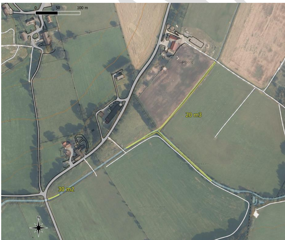
Figur 2-2. Ved Garborgforane og utløpssonen av Tjensvollbekken (sørøstgående bekkeløp) er det mye finstoff i bekkebunn i avmerkede soner, samt enkelte kalvende sandbanker som hadde hatt fordel av en opprensning.
