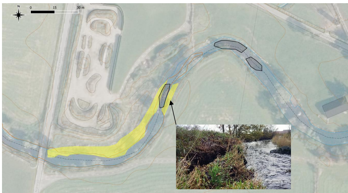
Figur 3-9. Oppstrøms Njølstadvegen, ved det nedre, vestre gyteområdet (svart skravur) er det pågående kanterosjon. Flere sandbanker kunne hatt fordel av noe utbedring i form av utslaking (gule partier). Økt tresetting foreslås også som tiltak.
