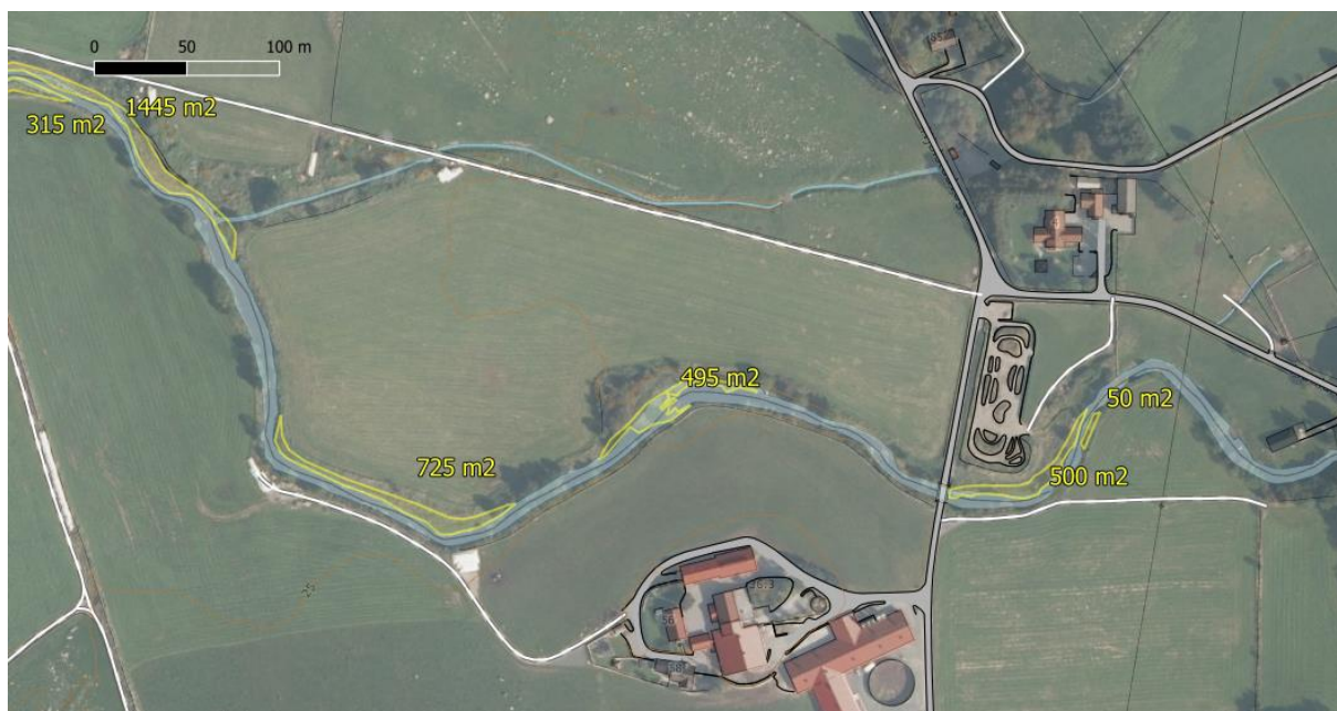
Figur 2-3. Forslag til opprensning av sedimentert masse i Tverråna oppstrøms og nedstrøms Njølstadvegen. Ved å fjerne sandbankene og massene som har etablert seg i og langs elveløpet vil elveareal frigis, flomteverrsnittet opprettholdes og de økologiske forholdene utbedres ved at bekkebunn og strømforhold blir mer naturpreget.
