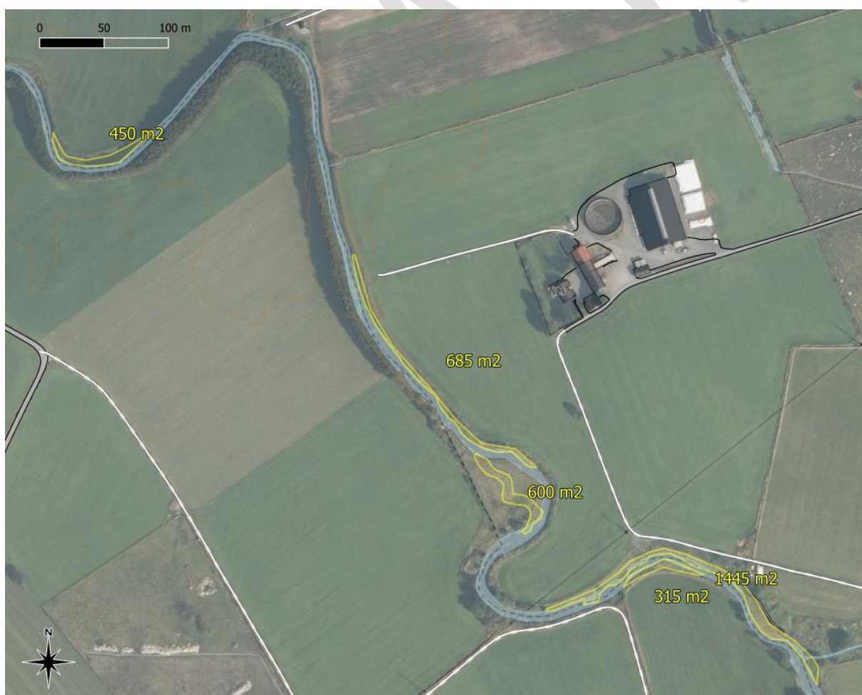
Figur 2-4. Forslag til opprensning av sedimentert masse i Tverråna nedstrøms Njølstadkanalen mot Sletteforen (nederst). Området avmerket på odden (600 m²) er av lavere prioritet enn øvrige sandbanker i selve elveløpet.
