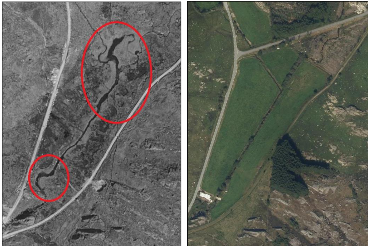
Figur 5.4. Eksempel på område med utretting i segment 9. Flyfoto fra 1954 (til venstre) og fra 2019 (høyre). Store svinger i elven er rettet ut og er i dag jordbruksland. Utretting vist her har redusert anadromt areal og elvens lengde med ca. 170 m. Bilder fra norgebilder.no .
