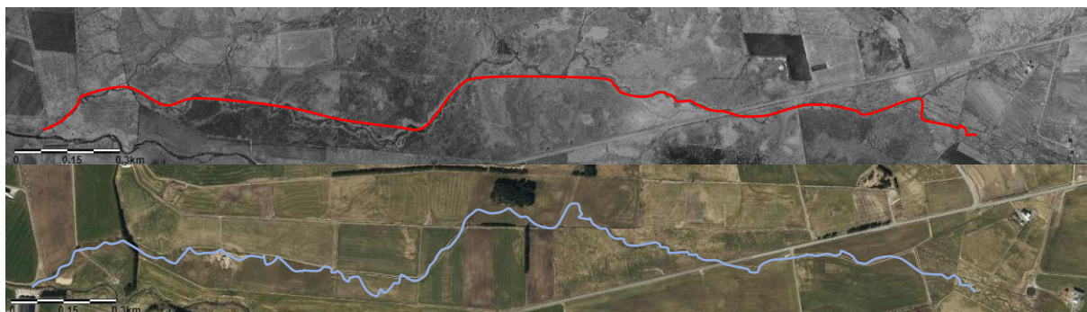
Figur 18. Flyfoto av Buvegbekken fra 1966 (oppe) og fra 2018 (nede). Bekken er stort sett helt utrettet. På bildet til oppe er elveløpet fra 2018 vist med rød strek, og på bilde fra 2018 (nede) er elveløpet fra 1966 vist med blå strek. Bilder fra norgebilder.no .
