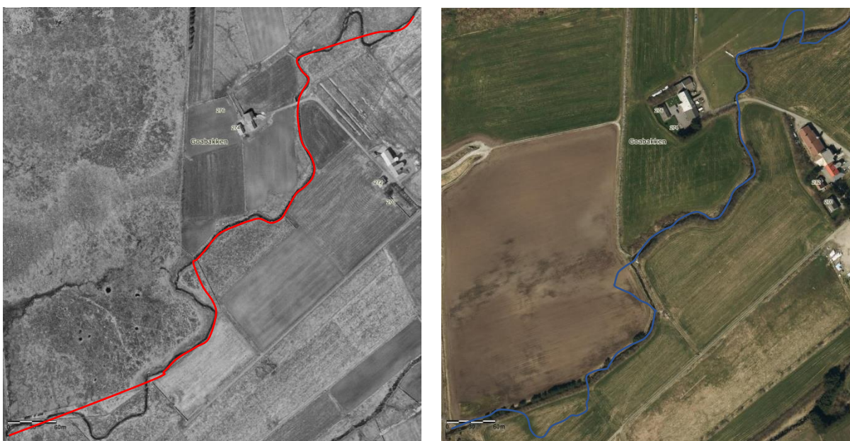
Figur 14. Flyfoto fra deler av segment N13 i Rongjabekken fra 1966 (til venstre) og fra 2018 (høyre). På bildet til venstre er elveløpet fra 2018 vist med rød strek, og på bilde fra 2018 er elveløpet fra 1966 vist med blå strek. Store svinger i elven er rettet ut og er i dag jordbruksland, men også mindre buktninger som skaper variasjon og dynamikk i et elveløp er rettet ut. Bilder fra norgebilder.no .
