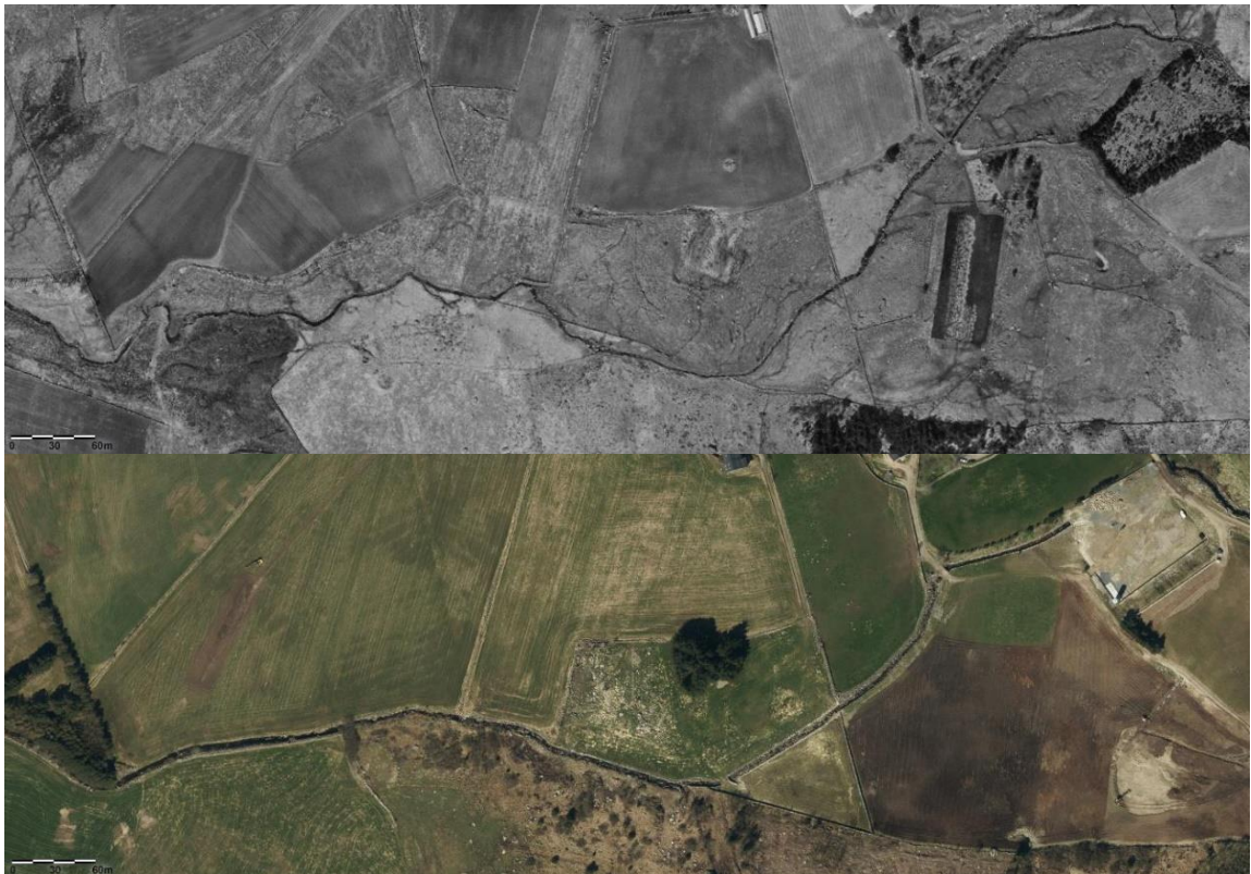
Figur 16. Flyfoto av segment S13 i Reiestadbekken fra 1966 (oppe) og fra 2018 (nede). Mange små buktninger og svinger er fjernet, og i øvre del (til høyre på bildet) er hele elven lagt i rør. Bilder fra norgeibilder.no .
