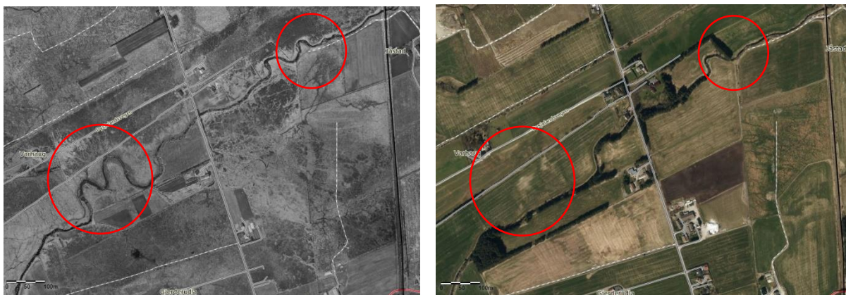
Figur 13. Flyfoto av segment N4 i Tvihaugbekken fra 1966 (til venstre) og fra 2018 (høyre). Store svinger i elven er rettet ut og er i dag jordbruksland. Fjerning av de to svingene til venstre i bildet har redusert elvens lengde med 150 m. Bilder fra norgebilder.no .
