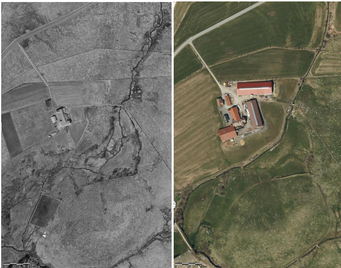
Figur 20. Flyfoto av Skrettingbekken fra 1966 (venstre) og fra 2018 (høyre). Hele elvestrekningen på bildene er flyttet eller utrettet og steinsatt i perioden fra 1966 til 2018. Bilder fra norgebilder.no .
