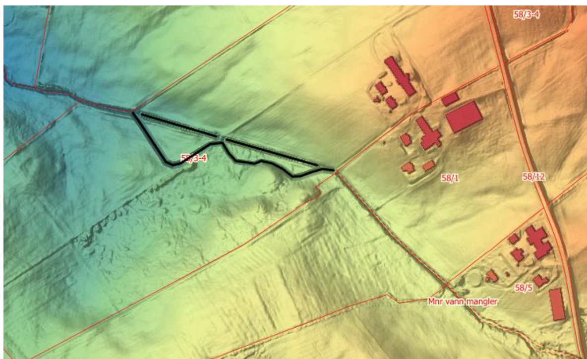
Figur 8. Eksempel fra Reiestadbekken ved Kydland, der gnr 58/3-4 krysses av bekken på skrå. Før i tiden slynget bekken seg nedover her, men den ble rettet ut. I dag er det mange trekantstykker som er vanskelige å dyrke, men ved gjenslynging av bekken oppnår bonden mer regulære dyrkningsenheter. Det er registrert gyteområder oppstrøms og nedstrøms dette område.
