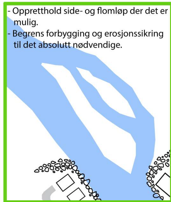
Fig. 7 Hovedprinsipp for miljøvennlig erosjonssikring – ikke mer en absolutt nødvendig
