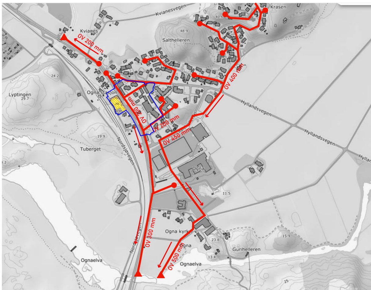
Figur. 8 Illustrasjonen viser ulike rørdimensjonar til det eksisterande OV-leidningsnett i høve planområdet.
