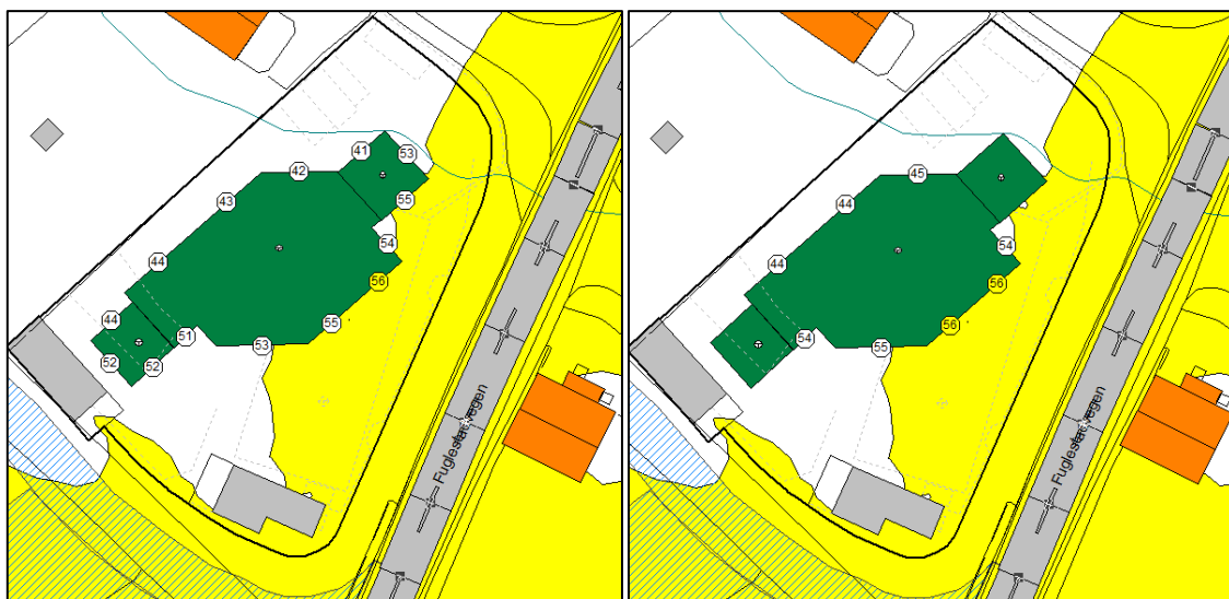
Figur 4. Støynivå L_d fra vegtrafikk ved fasade for henholdsvis 1. etasje og 2. etasje. Figuren viser beregnede støykoter i høyde 2,0 m over terrenget.
