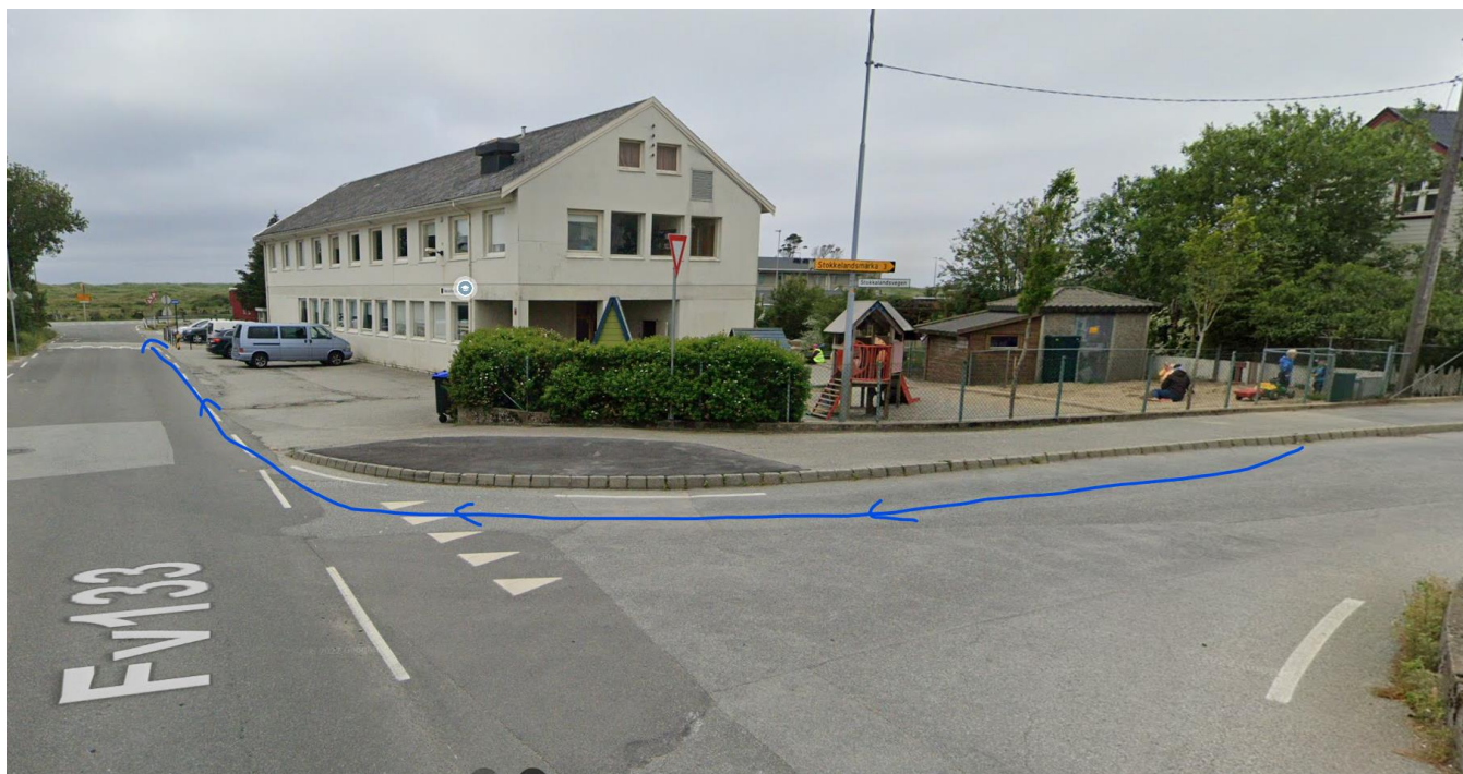
Figur 7: Flomvei for feltet nord for barnehagen, dersom vannet ikke havner i sluk/nettet.
